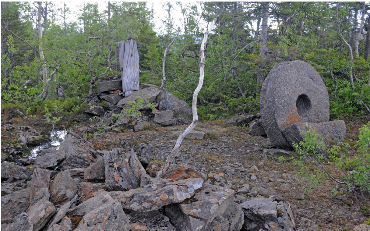
Fra kvernsteinsbruddet på Rya, sør for Rotla, med den siste kvernsteinen som ble laget, i 1914. I bakgrunnen ser vi restene av en spellkabbe, som ble brukt til å trekke steinene opp fra steinbruddet.
