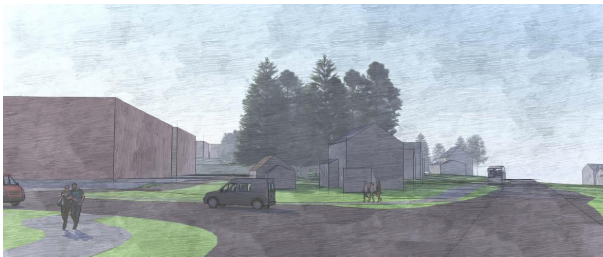
Figur 9. Illustrasjon av nytt kryss mellom fv. 705 og ny atkomstveg inn i næringsområdet. Det reguleres gang- og sykkelveg og fortau fram til bussholdeplass, sør for krysset. Eksisterende bebyggelse er vist grå, nye næringsbygg er vist brun.
