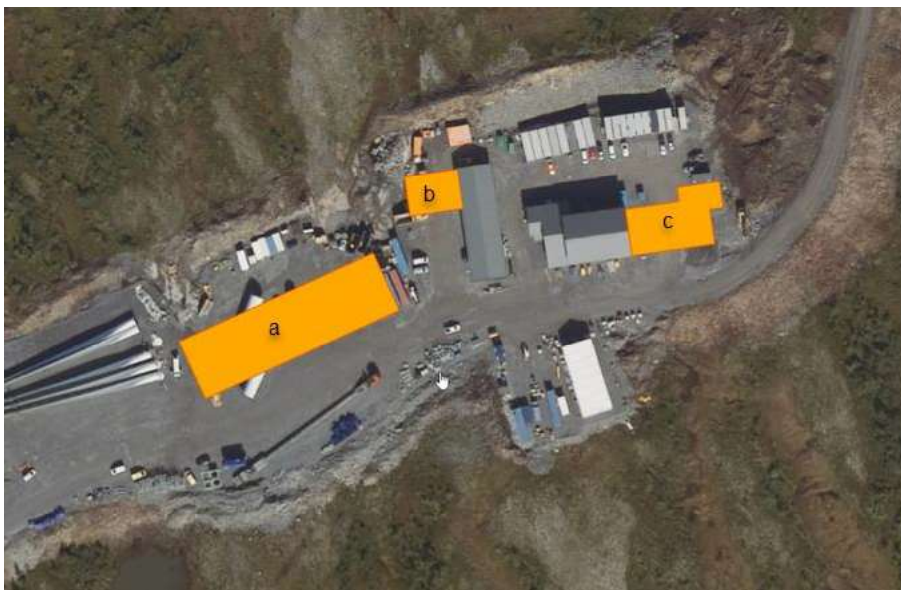
Figur 4 Planlagt utvikling av Stokkfjellet vindkraftverk med nytt bygg for a) batterianlegg, b) utvidelse av servicebygg og c) utvidelse av trafostasjon.
